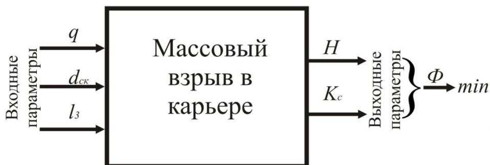
Рисунок 1 – Блок-схема массового взрыва как объекта управления
